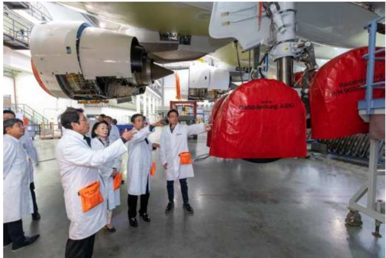
(3点ジャッキアップで赤いカバーをした車輪が浮いている状態)
