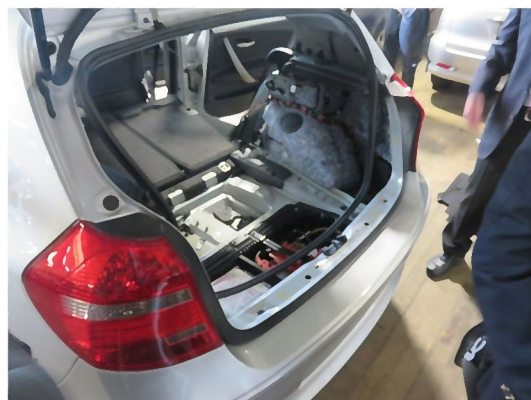
検査のため内張りを外し、車体をチェック
